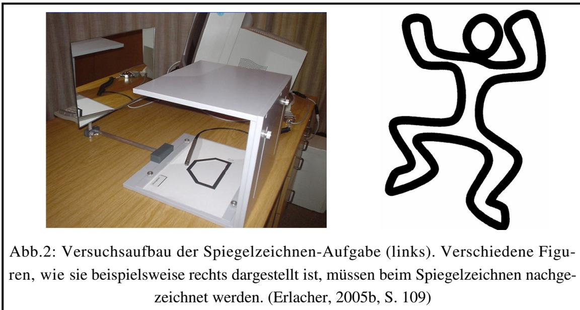
Abb.2: Versuchsaufbau der Spiegelzeichnen-Aufgabe (links). Verschiedene Figuren, wie sie beispielsweise rechts dargestellt ist, müssen beim Spiegelzeichnen nachgezeichnet werden. (Erlacher, 2005b, S. 109)
